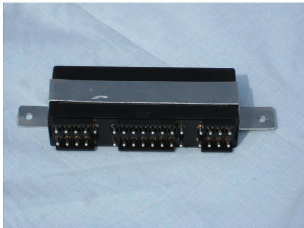
Abbildung 14: Befestigungsbügel für das EU-W126-LKM
