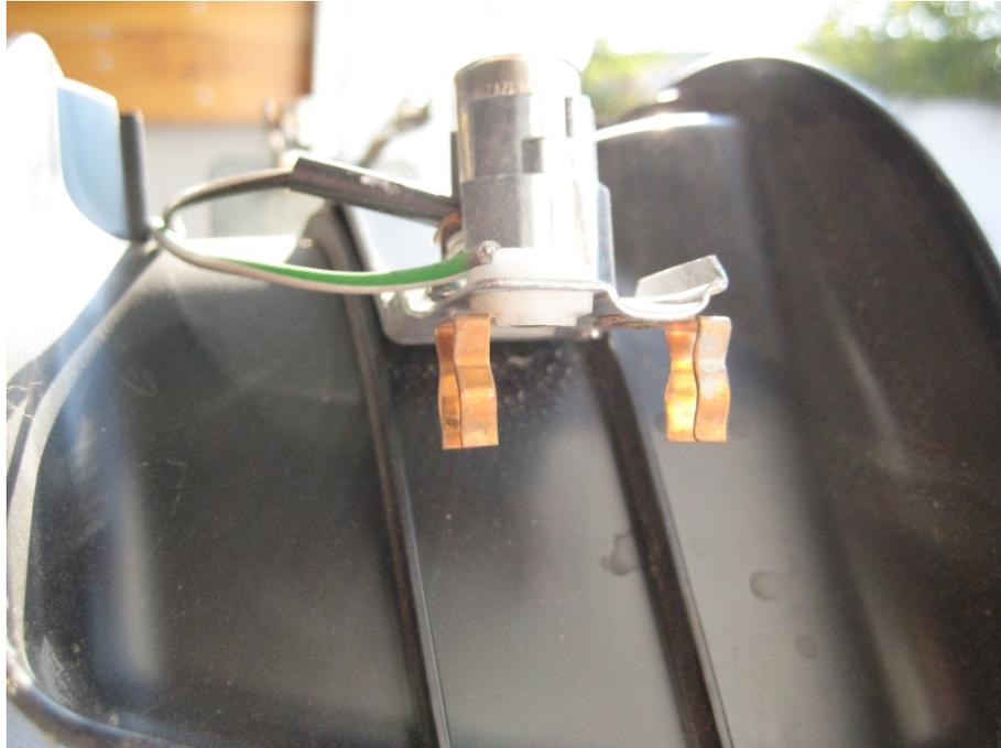
Abbildung 2: Soffittenhalterung für die hintere US-*sidemarker*-Leuchten
