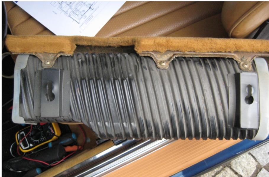
Abbildung 6: Demontierter Knieaufprallschutz
