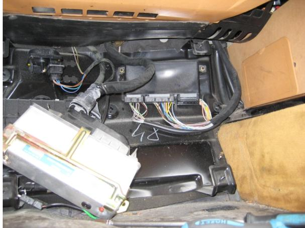
Abbildung 13: Position des LKM im Beifahrerfußraum
