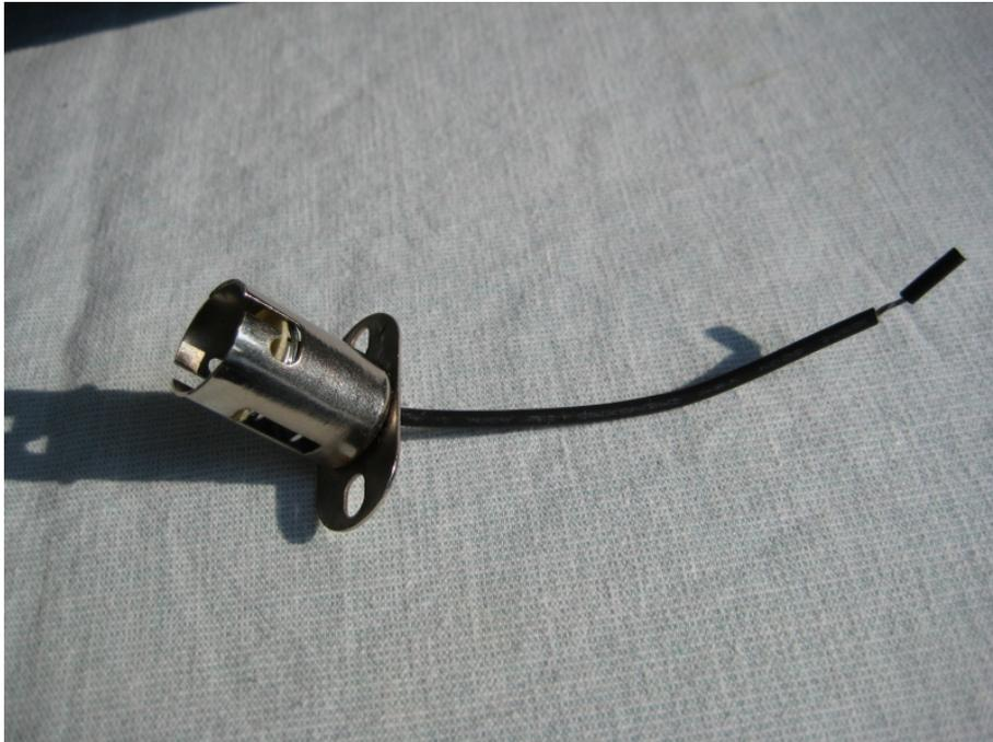
Abbildung 3: geeigneter BA15S-Lampensockel für die Nachrüstung der Nebelschlussleuchte
