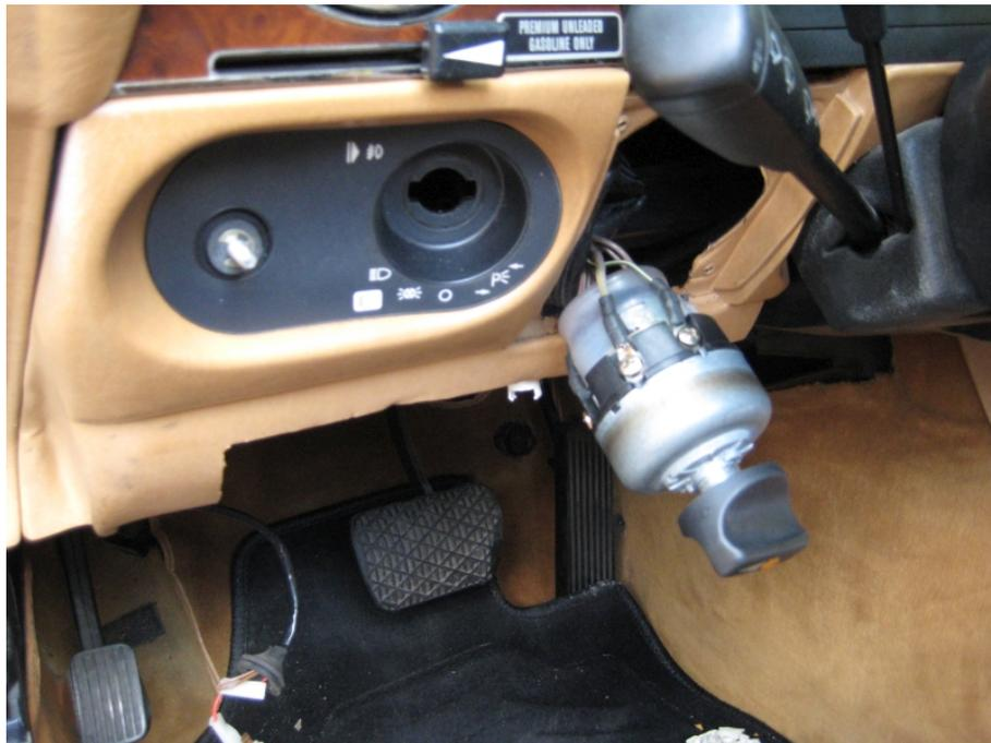
Abbildung 7: Demontierter Lichtdreheschalter
